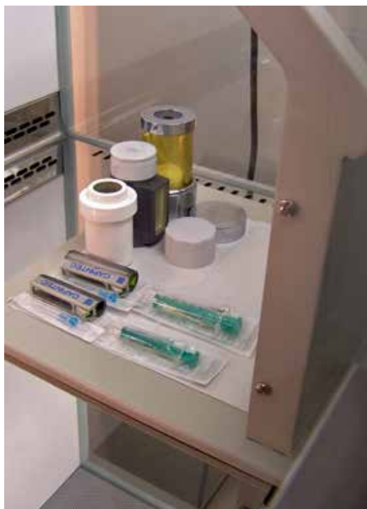
Ryc. 6.3 Osłony do elucji i iniekcji pod sterlnym przepływem laminarnym.
